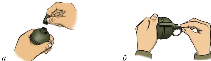
Іл. 4.1. Підготовка гранати до використання: а — вивинчування корка з трубки; б — угвинчення на місце корка запалу
