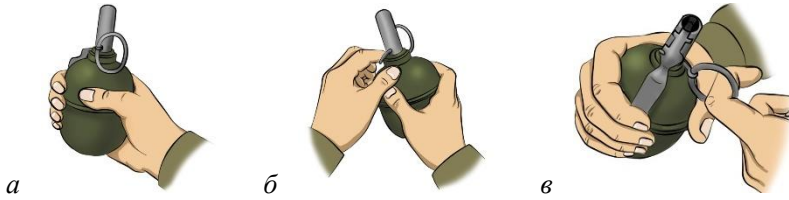
Іл. 4.2. Підготовка гранати до метання: а — притиснути спусковий важіль до корпусу гранати; б — випрямити кінці запобіжної чеки; в — висмикнути запобіжну чеку
