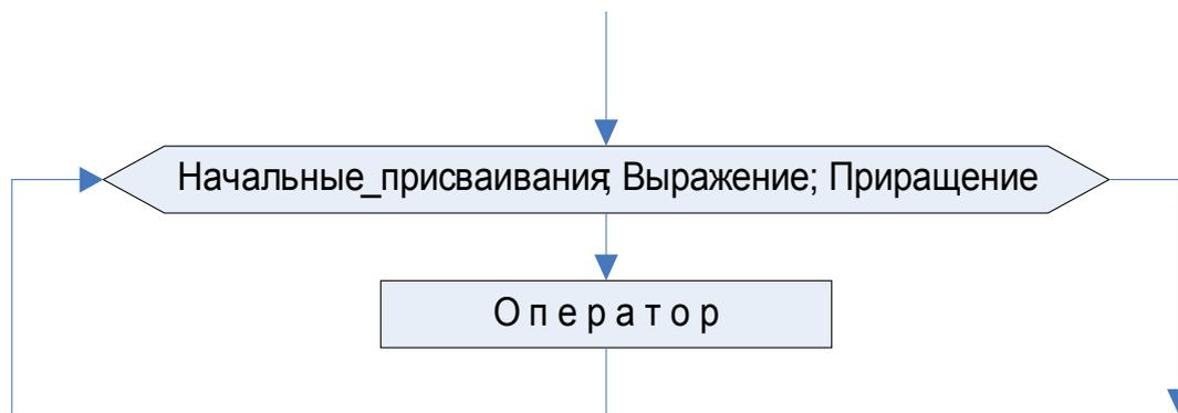
Рисунок 3.9: Блок-схема оператора for
