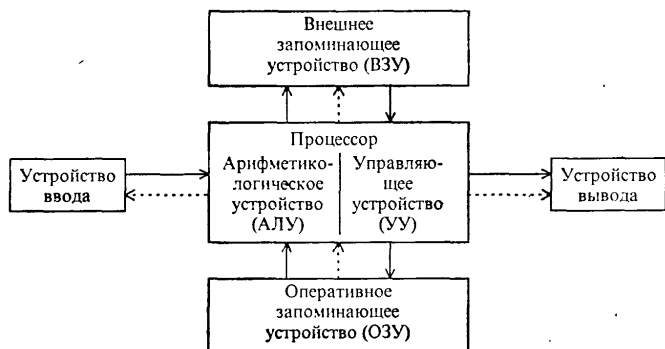
Рис. 19. Архитектура ЭВМ, построенной на принципах фон Неймана. Сплошные линии со стрелками указывают направление потоков информации, пунктирные – управляющих сигналов от процессора к остальными узлам ЭВМ.
