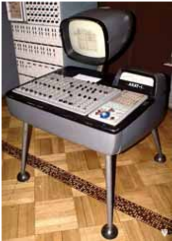
Рис.15. Польский электронный аналоговый компьютер «АКАТ-1».
