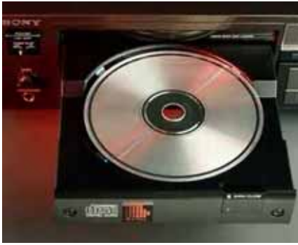
Рис. 20. Компьютерный компакт-диск. При записи твёрдотельный лазер «выжигает» информацию на диске в виде крошечных углублений. При поиске такой же лазер используется (но в режиме пониженной мощности) для «чтения» информации: отраженный свет лазера преобразуется в электрические сигналы, которые воспроизводят первоначальную информацию. Положение лазера в режиме записи и поиска задается линейными двигателем и оптическим датчиком. 1 - подложка; 2 – слой.
