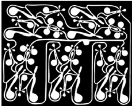
Рис. 17. Струйная плата для компьютера, полученная химическим травлением пластмассы.
