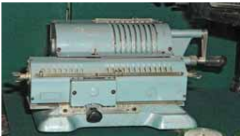
Рис. 4. Арифмометр «Феликс» - самый распространённый в СССР. Выпускался в 1929-1978.
