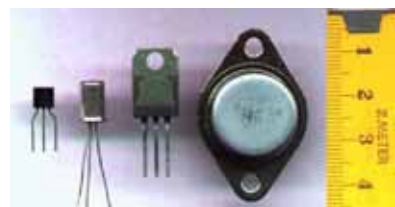
Рис. 8. Транзисторы, в качестве миниатюрной и более эффективной замены электровакуумным лампам, совершили революцию в вычислительной технике.
